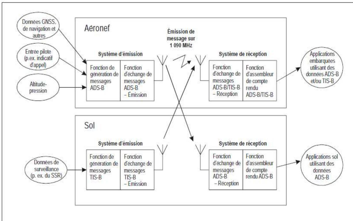
Figure 5-1. Modèle fonctionnel de système ADS-B/TIS-B
