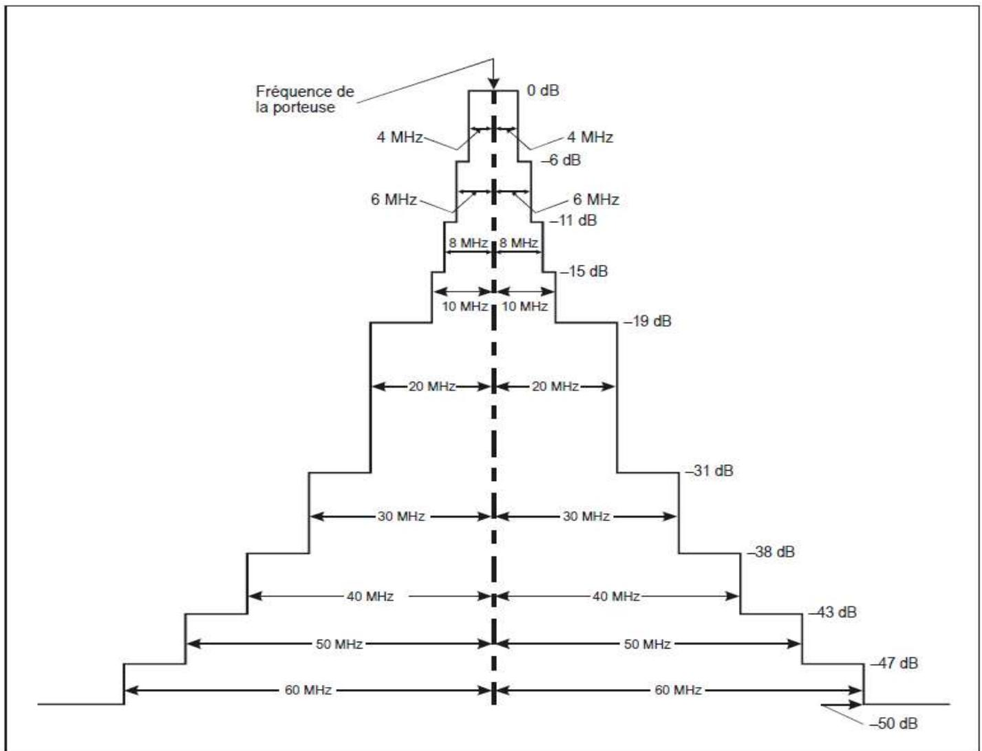
**Figure 3-2. Limites du spectre pour l'interrogateur**
