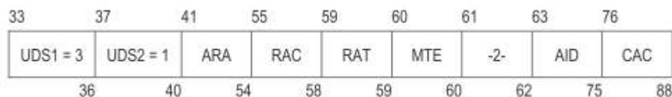
4.3.8.4.2.3.4.2 *Systèmes conformes à l'ACAS X : Sous-champs de MU dans une diffusion d'avis de résolution (message d'interrogation de diffusion d'avis de résolution)*. Lorsque UDS1 = 3 et UDS2 = 1, le champ MU renfermera les sous-champs suivants :
