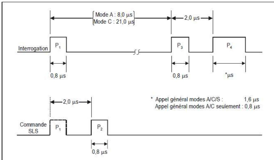
Figure 3-3. Séquence d'impulsions d'interrogation intermodes
