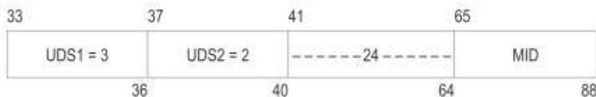
4.3.8.4.2.3.4 Sous-champs de MU dans une diffusion d'avis de résolution (message d'interrogation de diffusion d'avis de résolution)
