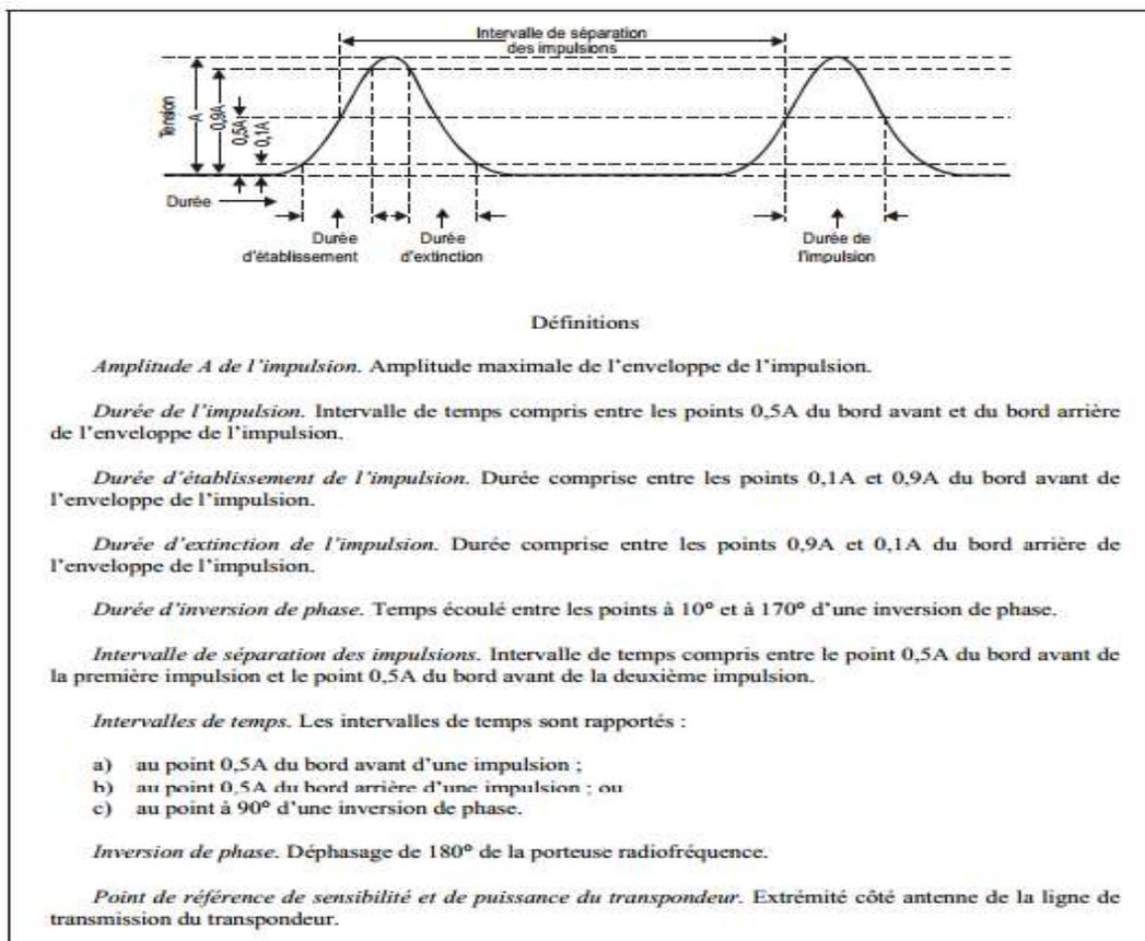
**Figure 3-1. Définitions des formes d'onde du radar secondaire de surveillance, des intervalles de temps et du point de référence de sensibilité et de puissance du transpondeur**
