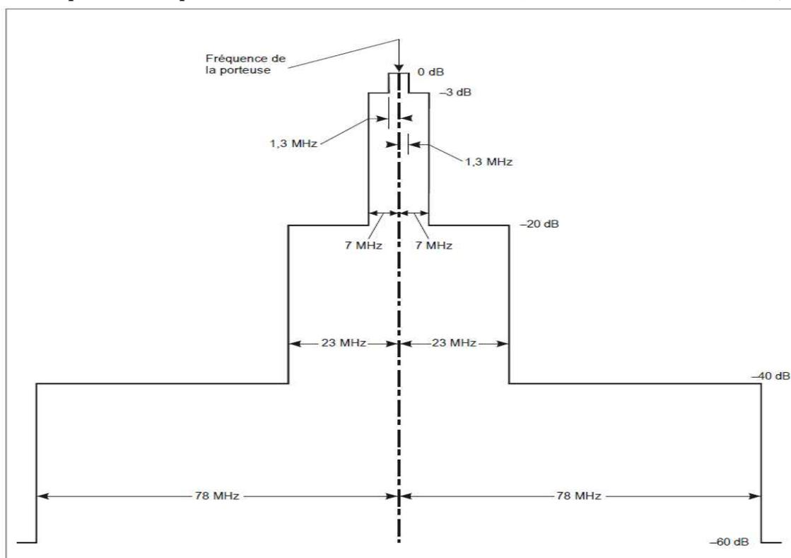
Figure 3-5. Limites du spectre pour le transpondeur
