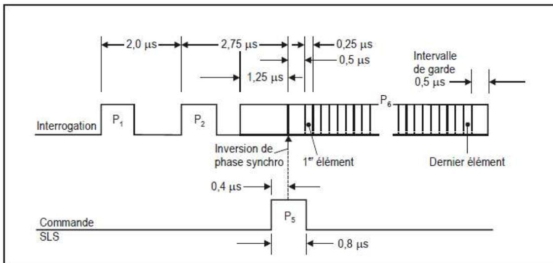
Figure 3-4. Séquence d'impulsions d'interrogation mode S
