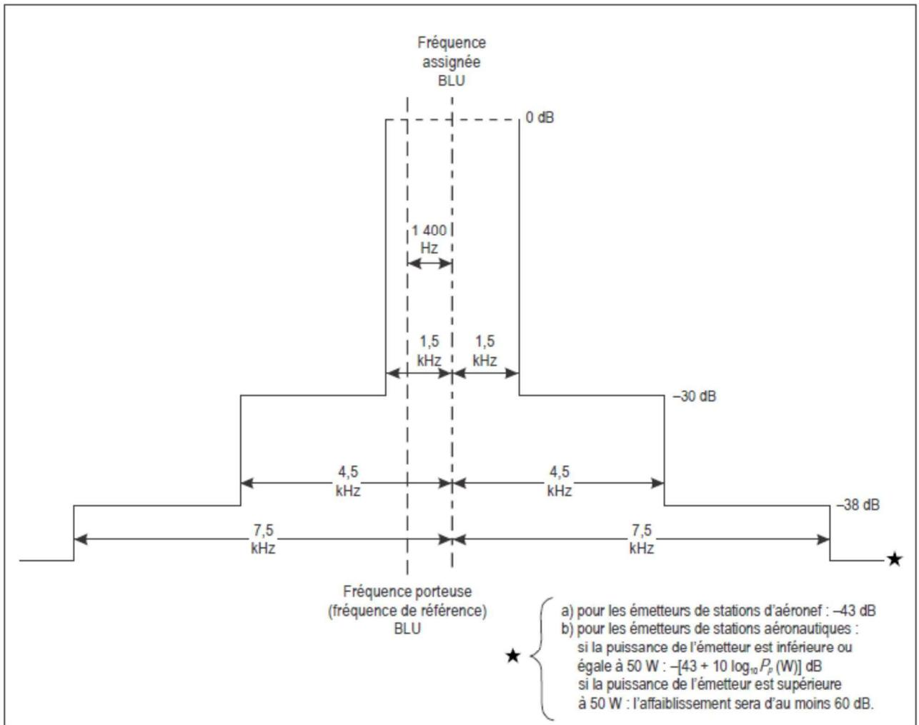
Figure 2-2. Limites du spectre requises (sous forme de puissance de crête) pour les émetteurs de stations d'aéronef installés pour la première fois après le 1<sup>er</sup> février 1983 et pour les émetteurs de stations aéronautiques en service après le 1<sup>er</sup> février 1983
