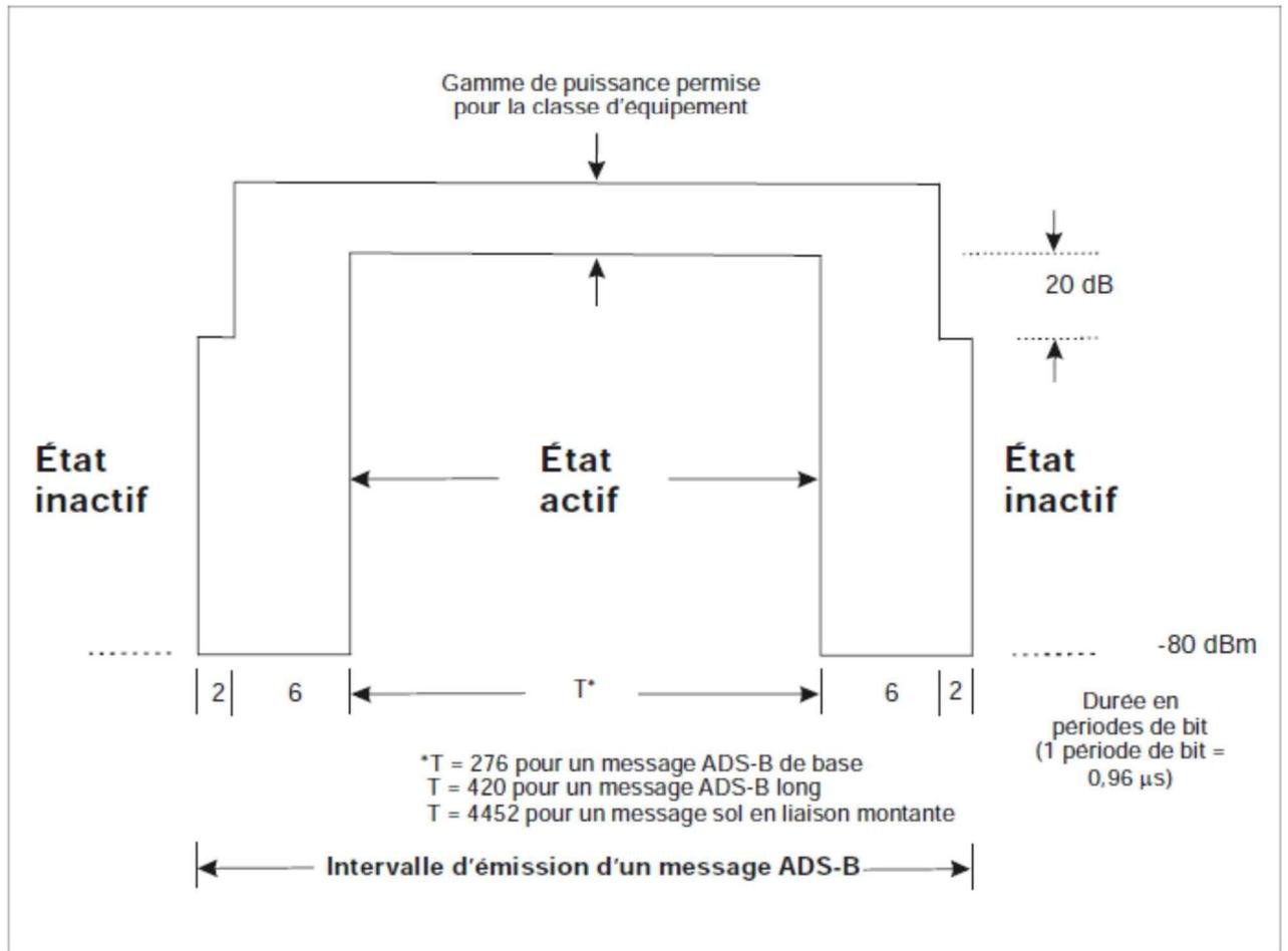
Figure 12-2. Profil temps-amplitude d'une émission d'un message UAT
