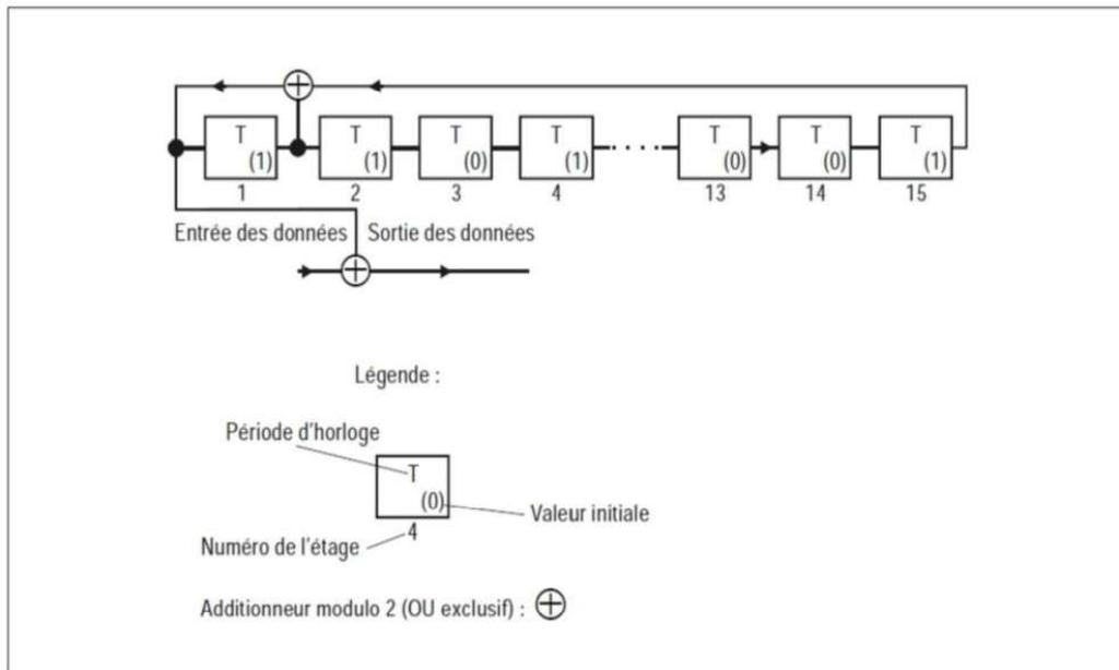
Figure 6-2. Générateur de PN pour la séquence d'embrouillage des bits
