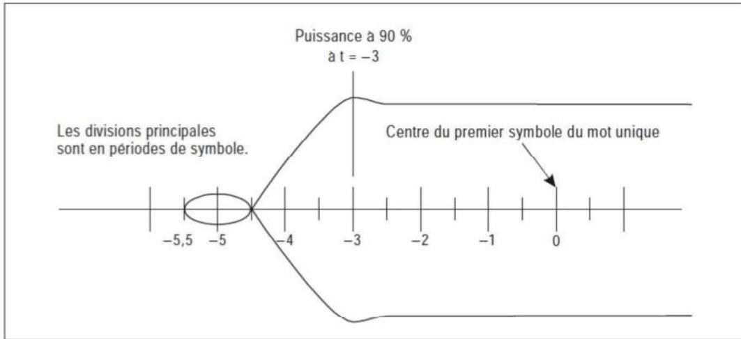
Figure 6-1. Stabilisation de la puissance de l'émetteur
